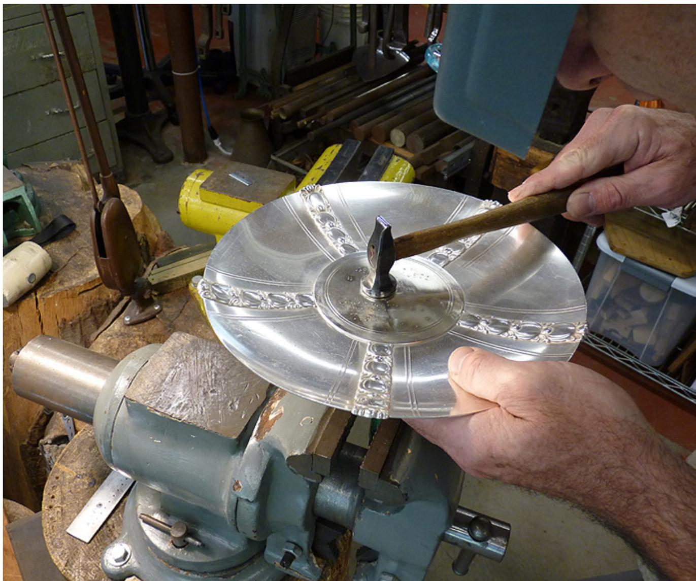
A libra depositada foi então planejada sobre uma estaca ligeiramente abobadada para remover qualquer porosidade deixada pela soldagem. Em seguida, o papel molhado / seco de carboneto de silício de 600, 1200 e 2000 foi utilizado para remover quaisquer manchas altas e preparar a superfície para polir.
