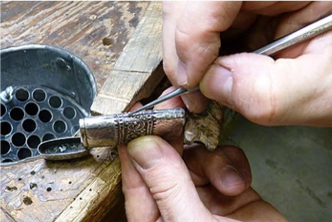
Esta ferramenta dental modificada possui um raspador triangular estreito no final. É usado para remover toda a solda na junta, de modo que o fio de enchimento seja soldado à libra esterlina. As tecnologias de arco de pulso e laser não se fundem com sucesso para soldar que já derretido. O metal de enchimento irá combinar com a solda existente e produzir uma liga granulada com uma cor que não coincida com o material circundante.
