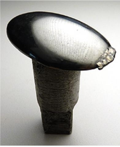
no chão do meu cimento. Eu usei a configuração de aço inoxidável no PUK e reconstruí a peça faltante com algum fio de aço suave e pesado, depois remodelou a área reparada. (Mostra a área soldada antes do acabamento). Não há limpeza de fluxo bagunçado e você manterá o acabamento no resto da sua ferramenta - não repolindo. Se você tem uma participação de T muito pesada com alguma porosidade,
