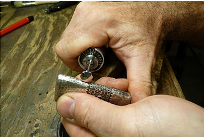
Um compactador rotativo é usado para martelar e comprimir o fio esterlino que foi usado para a solda.
