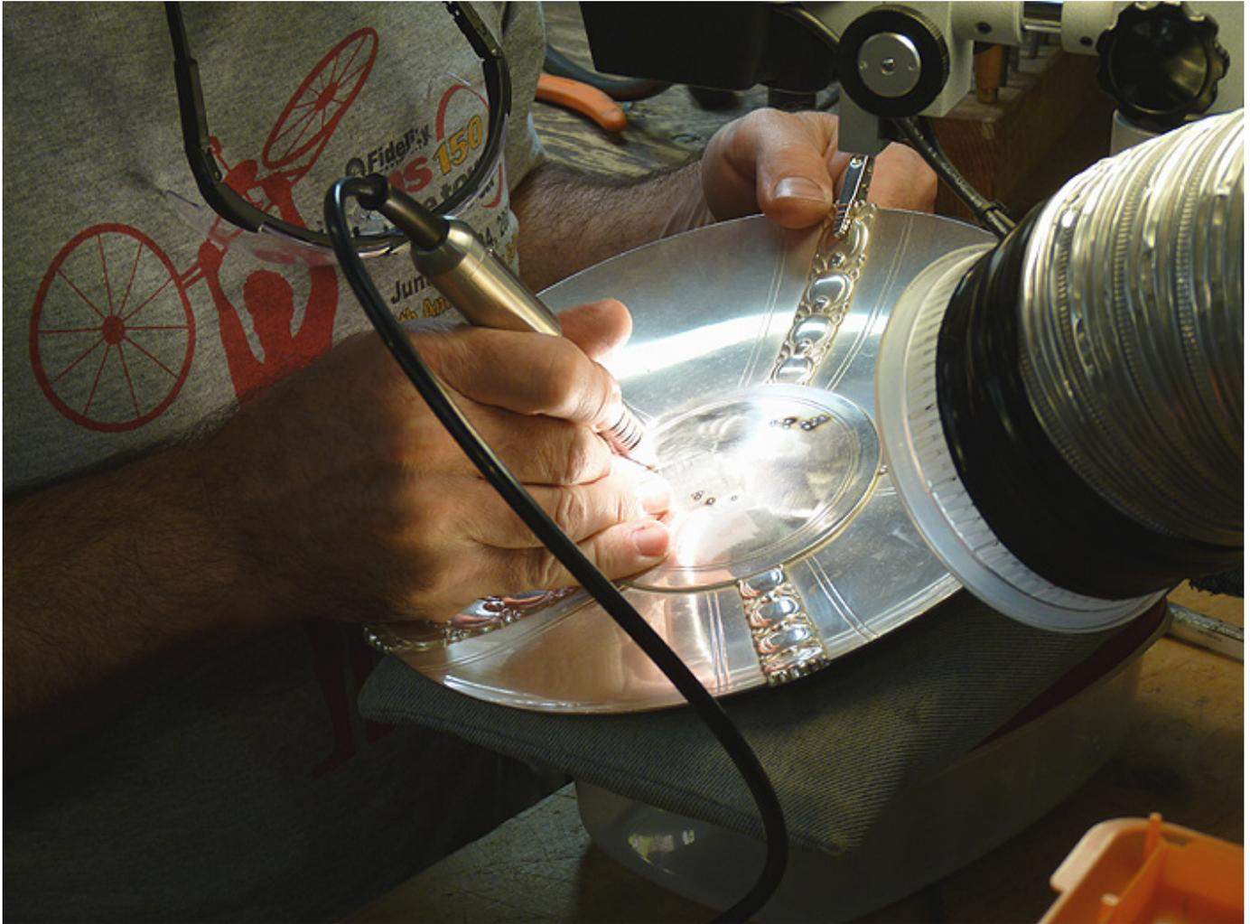
Acima, estou aplanando os montes esterlina cheios demais com um modo de suavização especial. Todo esse processo de enchimento e suavização foi extremamente demorado, exigindo uma concentração enorme e uma reorientação constante do microscópio 10x.
