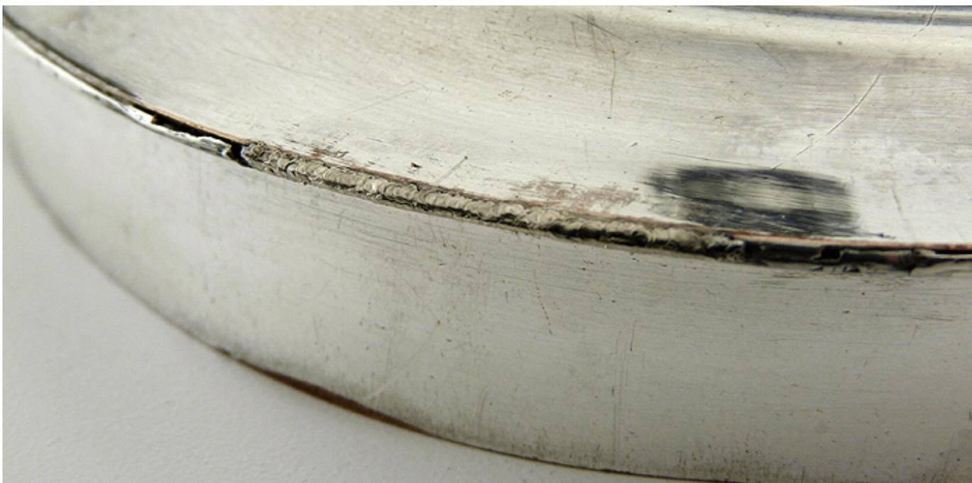
**15/01/2014:** Este clipe de dinheiro desenvolveu uma fenda de estresse, em seguida, quebrou de muitos anos de uso. Foi soldado de volta com o fio de paládio / prata. A remoção da moeda poderia danificá-la e a brasagem da divisão teria suavizado o metal sem a forma de endurecer o grampo geral. Devido à tensão exercida na mola, a folha de prata foi adicionada à coluna vertebral para suporte extra.
