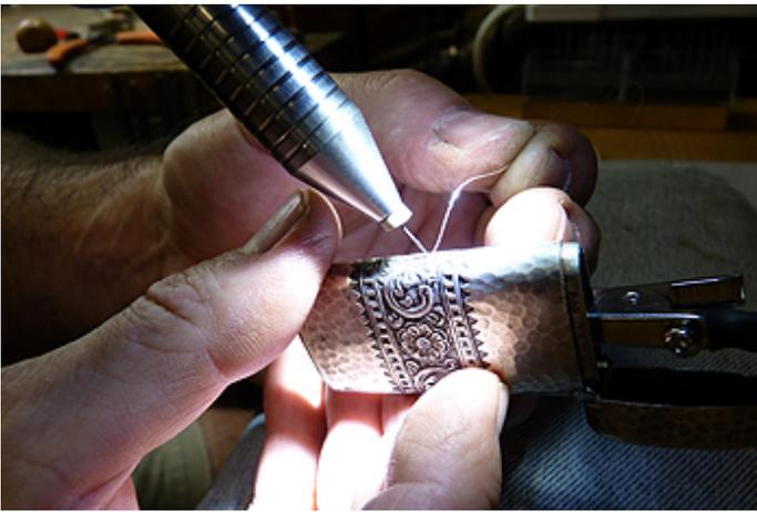
soldadura forte com solda de prata dura. A soldagem em prata teria levado muito mais tempo: fundindo a peça para evitar firestain, limpeza da junta de solda em torno dos detalhes perseguidos e extensa repatinação. A soldagem por arco de pulso localiza o calor e rodeia a área de solda com gás argônio. Este gás elimina totalmente os óxidos de formar na libra esterlina.
