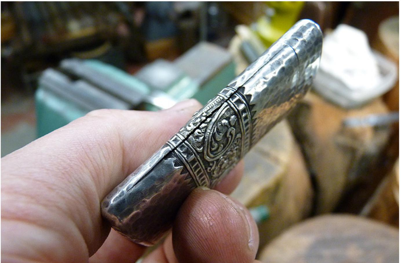
O reparo mais tedioso deste cofre foi fechar a costura (ou junta). A primeira ordem dos negócios foi abrir a costura para remover qualquer solda. A lã de aço ultra-fina 0000 foi utilizada no interior para remover qualquer sujeira em torno da costura, tornando a superfície lisa para polir.
