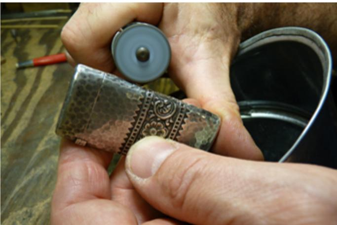
Uma roda abrasiva de borracha fina remove as imperfeições do compactador.
