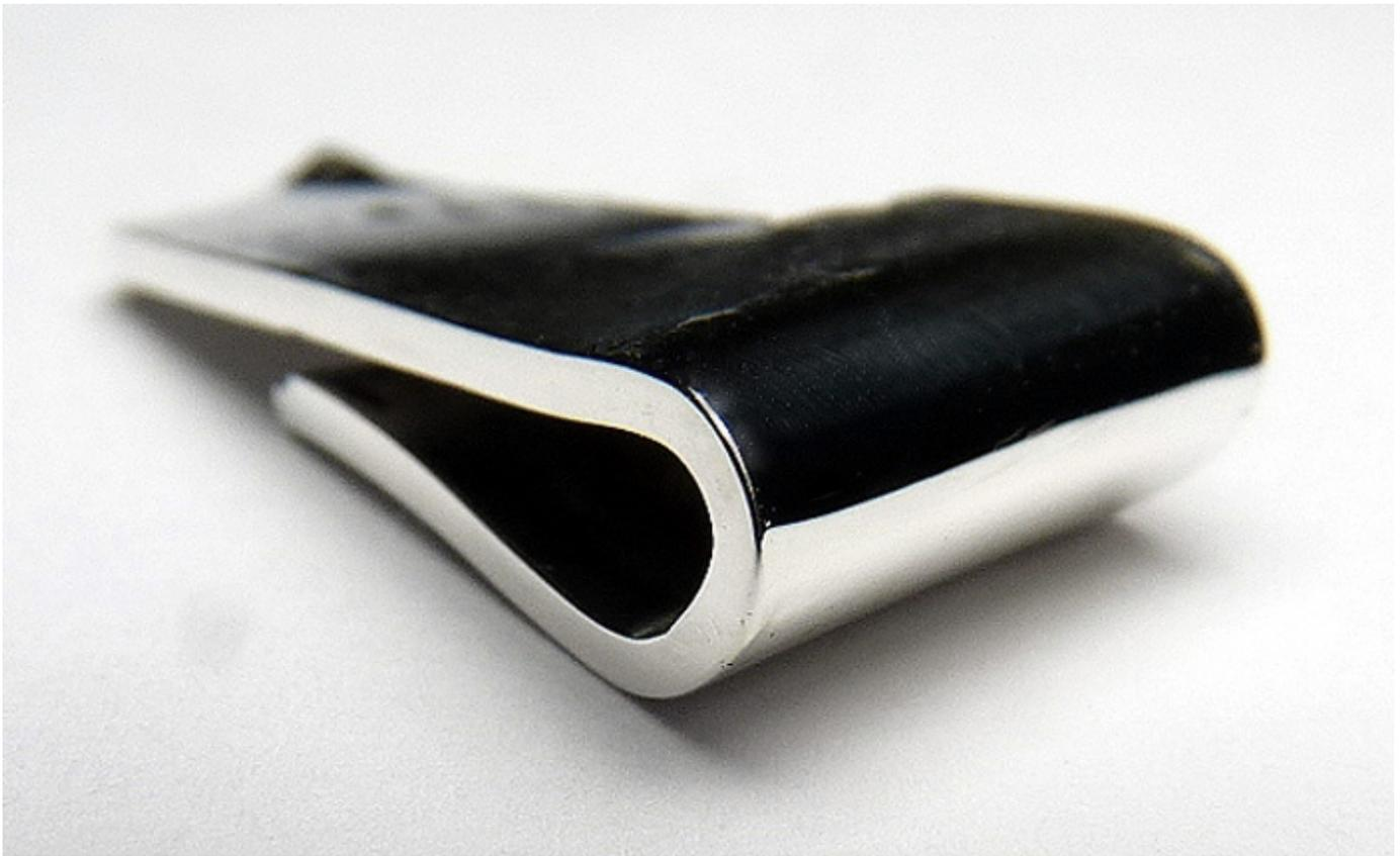
**Teste de Argentium Sterling:** usei a mesma técnica usando o laser Argentium e a solda de soldagem de arco na folha de 935 Argentium (abaixo), mas esta peça foi martelada plana depois de dobrar. Impressionante.
