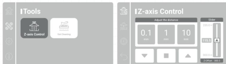
**3** Siga as instruções na tela para executar a calibração do eixo Z;
