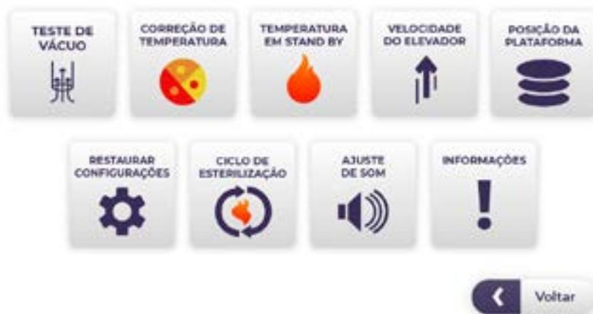
**[CORREÇÃO DE TEMPERATURA]:** Realiza ajuste na temperatura do forno.
