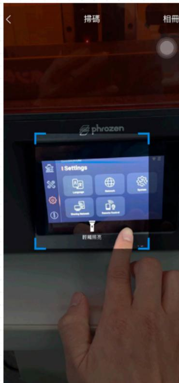
No painel de toque da impressora 3D, toque em **"Configurações"** e escolha **"Controle Remoto"** para acessar o código QR da impressora 3D.
