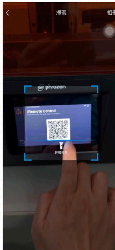
Digitalize o código QR fornecido na tela da impressora 3D para vincular sua conta e confirme a conexão na tela da impressora 3D.
