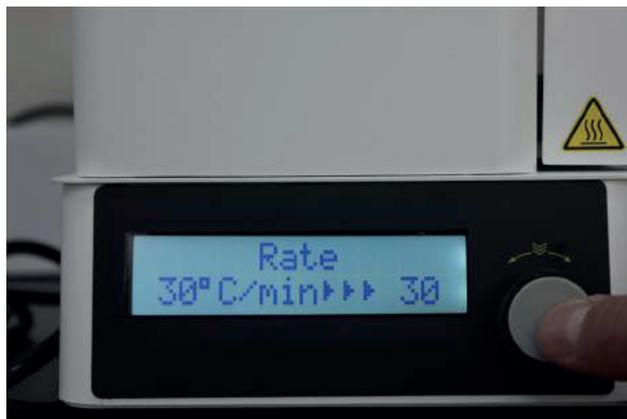
Velocidade de subida da temperatura ou rampa.
