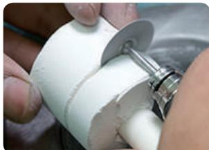
Abra o anel de revestimento com um disco e quebre no ponto determinado.
