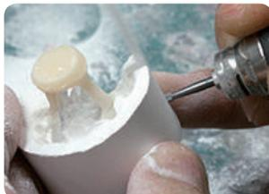
Remova o excesso de revestimento utilizando um jato com esferas de vidro até 60 psi de pressão até visualizar os elementos.
