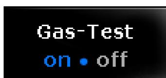
Apertando o botão correspondente causa a válvula de gás ser aberta. Essa função é importante para regular o nível de gás correto no regulador de fluxo (veja cap 5.4). Apertando novamente causa a válvula do gás ser fechada. Além disso, qualquer operação do equipamento sai do teste de gás.
