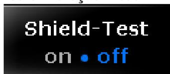
Apertando esse botão causa uma troca da proteção visual de claro para escuro. Isso permite uma função correta de proteção visual e checka o sistema. Apertando novamente o botão sai do teste.
