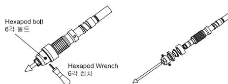
Desmonte a caneta usando uma chave hexagonal. Assim, todas as partes podem ser desmontadas.
