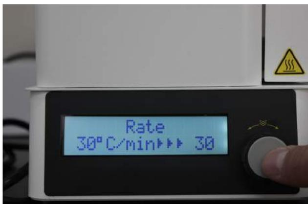
Velocidade de subida da temperatura ou rampa.
